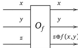
où  $x, y, z$  sont des bits classiques 0 ou 1. La sortie de la troisième ligne est  $z \oplus f(x, y)$ .
