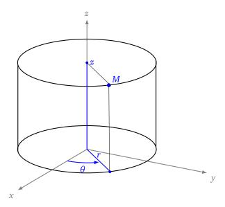
Ces coordonnées sont uniques lorsque r > 0 et  $\theta \in ]-\pi,\pi[$ . Elles s'apparentent aux coordonnées polaires avec en plus une hauteur z. Elles sont particulièrement adaptées lorsque la configuration possède un axe de rotation. Les formules inverses sont similaires à celles pour les coordonnées polaires :
